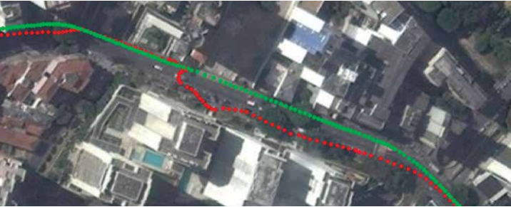
Atténuation des multi-trajets en canyon urbain : GNSS seul – rouge ; imajbox® – vert
